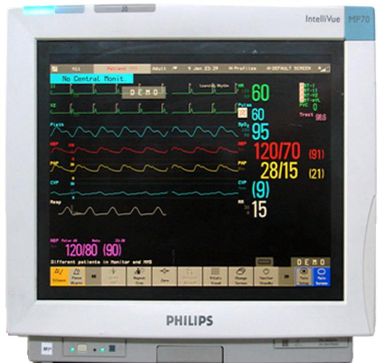
El Monitor Signos Vitales Philips MP70 integra una pantalla LCD a color de 15 pulgadas con una unidad de procesamiento de datos en un solo dispositivo.
